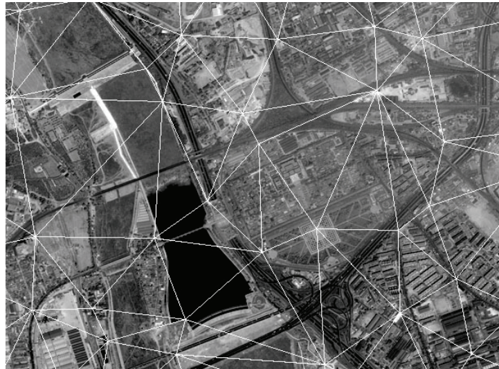
图 9 光学图像上提取的特征点及其构建的三角网
