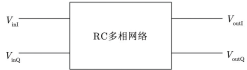
图 3 等效 4 端口 RC 多相网络
