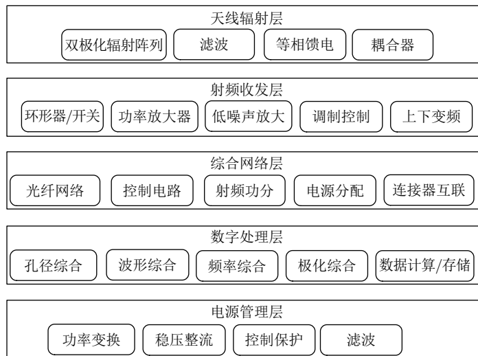
图 5 有源子阵各功能分层的构成要素
