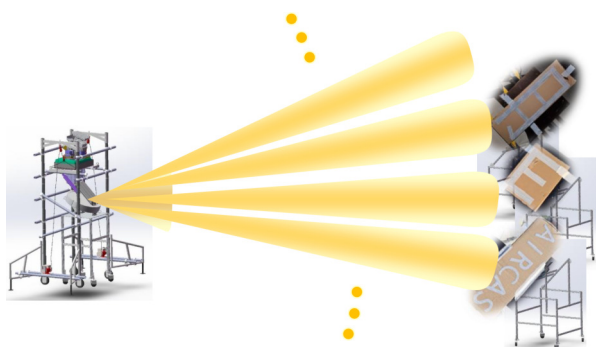
图9 地面成像的ISAL雷达和转台装置示意图
