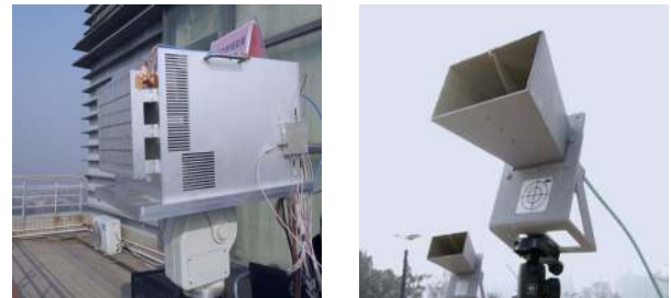
(a) 射频天线 (a) RF antenna (b) 假目标产生器 (b) False target generator
