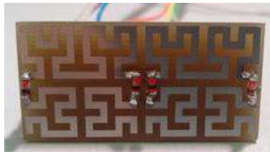
图2 电可控Hilbert吸波可重构超表面
