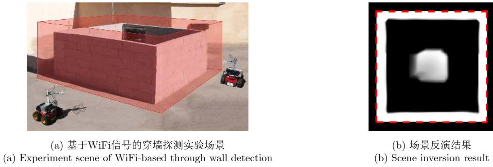
图 16 基于WiFi信号的机器人平台穿墙探测及场景反演结果 [57]
