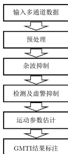
图 14 多通道算法主要处理流程
