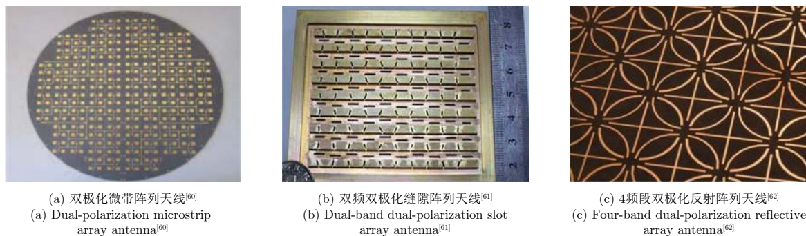
图3 几种新型的多频双极化单脉冲天线
