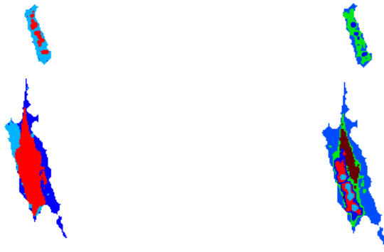
图 10 H/\bar{\alpha} /Wishart 分类器 6 次迭代分类结果 Fig. 10 Result with 6 iteration with H/\bar{\alpha} /Wishart algorithm
