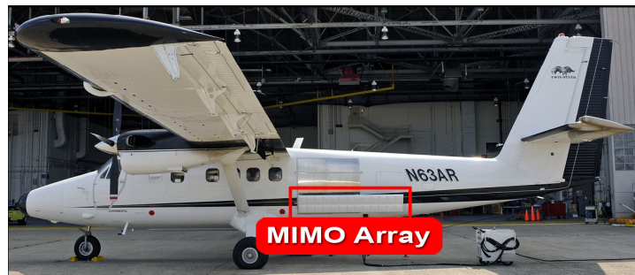
图3 机载MIMO雷达飞行试验(双水獭飞机)
